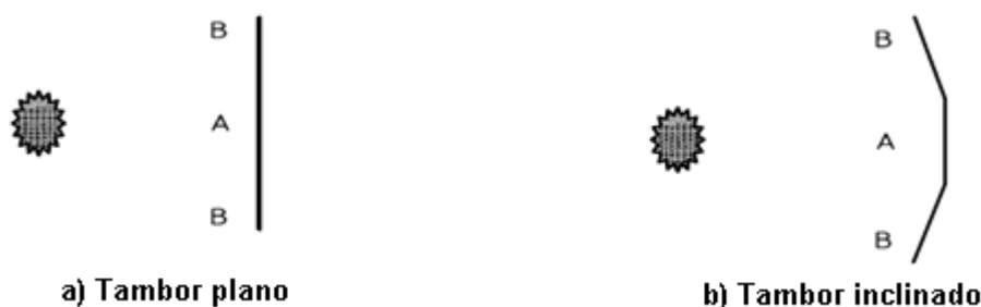
FIGURA A.1 –Medición de la radiación en equipos que utilizan un tambor rotatorio de especímenes.
